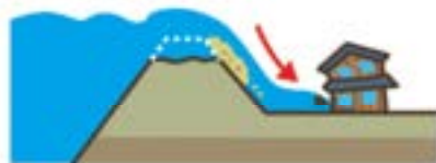
氾濫流による家屋倒壊等
