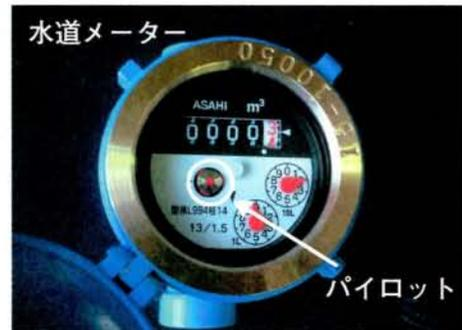
水を使用していないのにパイロットが回っているときは漏水しています。
