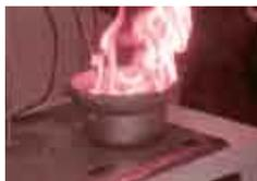
すべてに安全装置がついているIHクッキングヒーターは火を使わないので安全のように思えますが、使い方を間違えると火事になることがあります。その原因は鍋などが変形している場合で、鍋底に凸凹があると温度センサーに接触せず、この状態で油を入れて加熱すると安全装置が作動しないまま過熱状態が続き、鍋の中の油が発火し火災につながる場合があります。
