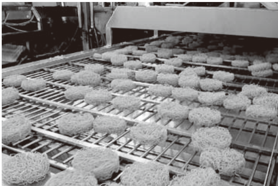
皿うどん製造ライン。厳選した小麦を使用し、良質な油で揚げた自慢の麺。地球環境に優しい、廃油を出さないシステムを業界で初めて導入しています。
