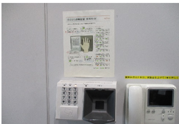
図 6-15 手のひら認証による入退室管理の例
