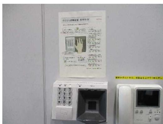
図 6-26 ICカードや手のひら認証による入退室管理の例
