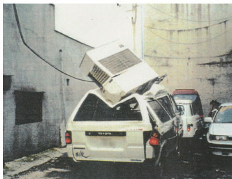
写真2-25 強風で屋上から落下したエアコン室外機(1991年台風19号災害)
