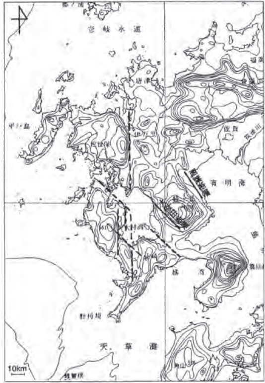
図1-16 西九州の接峰面図に現れた大村湾の基本形を規定している構造線(破線)と断層(実線) (九州活構造研究会(1989)「九州及び周辺の接峰面図と海底地形図」の一部に加筆)
