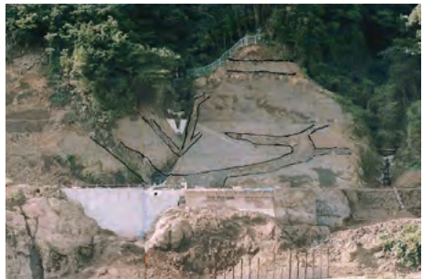
写真1-9 玄武岩岩脈 蒼瀬ダム左岸の郡川火山岩類の凝灰角礫岩を幅30～80cmの数本の玄武岩質岩脈が貫いている
