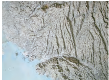
写真1-20 地形模型に現れた活断層 多良火山麓扇状地を切る松尾・小川断層とその南の向木場断層がわかる。写真中央の横筋が小川断層
