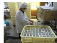
フィルムを貼って包装が完了します。このフィルムには小さな穴が開いており、納豆菌が呼吸できるようになっています。
