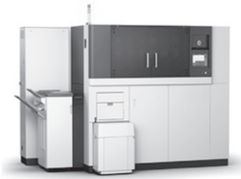
（使用済みの紙を原料として、水を使わずに新たな紙を再生する再生紙製造機「ペーパーラボ」）
